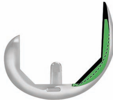
Figura 5: Surco troclear estándar (verde) vs. Surco troclear más profundo y pronunciado distalmente Vanguard
