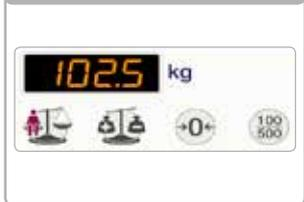
La báscula integrada es fácil de usar y admite hasta 250 kg (550 lb). El pesaje puede llevarse a cabo en cualquier posición. También es posible añadir o quitar elementos usando la función de auto-compensación, sin que afecte al peso del paciente.
