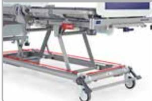
Los sensores anti-atrapamiento pueden detectar la presencia de un objeto o una persona debajo de la cama. Si se interrumpe el haz mientras se está bajando la plataforma del somier, esta se moverá automáticamente hacia arriba, alejándose de la obstrucción, lo que reduce el riesgo de atrapamiento.
